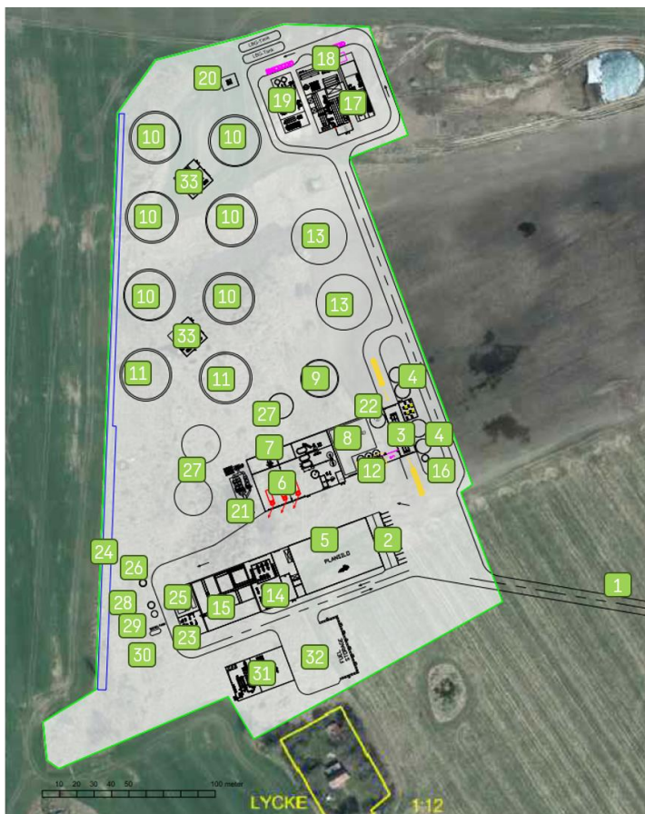
Figur 1. Layout över biogasanläggningen och anläggningen för flytgödselmottagning.
